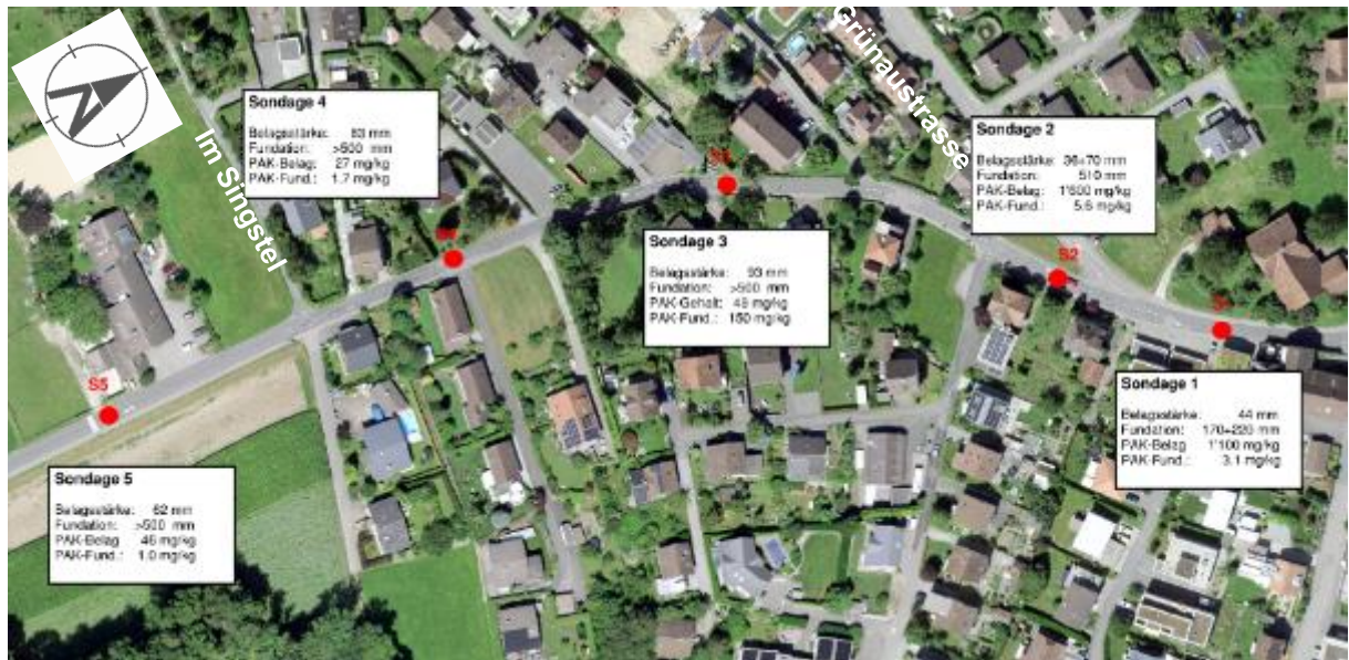
Abbildung 2: Übersicht Sondagen; materialtechnische Untersuchungen (Quelle: AGIS)
